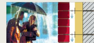
Zweischalig steht für Schlagregenschutz: Lüftungsfugen in der Vormauer und die Luftschicht zwischen Vormauer und Hintermauer sorgen für eine freie Luftzirkulation und eine schnelle Entfeuchtung. Das optimale Feuchtigkeitsverhalten des Backsteins leistet einen weiteren Beitrag zu einem wirksamen Schutz für Dämmschicht und Hintermauerwerk.
