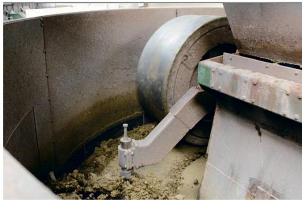
**Herstellung des Rohmaterials:** Im „Kollergang“ werden Ton, Sand und aufbereiteter Bruch vermisch, bevor das Ganze durch eine Strangpresse gedrückt wird (siehe unten). Fotos: Heinzl
