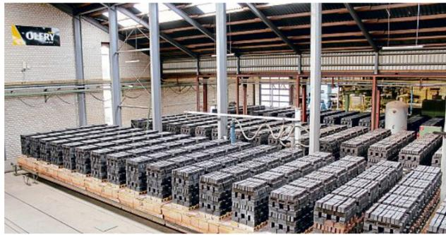
**Beeindruckende Zahlen:** 350 000 Ziegel werden drei Tage lang im Ofen bei bis zu 1200 Grad gebrannt, bevor sie versandt werden können.
