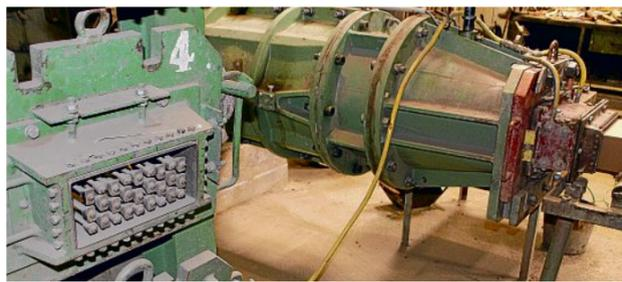
**Strangpresse:** Unterschiedliche Pressköpfe für unterschiedliche Ziegel (oben). Über einen Schwindungsmarkierer erkennt das Labor wie stark der Ziegel „geschrumpft“ ist (unten).
