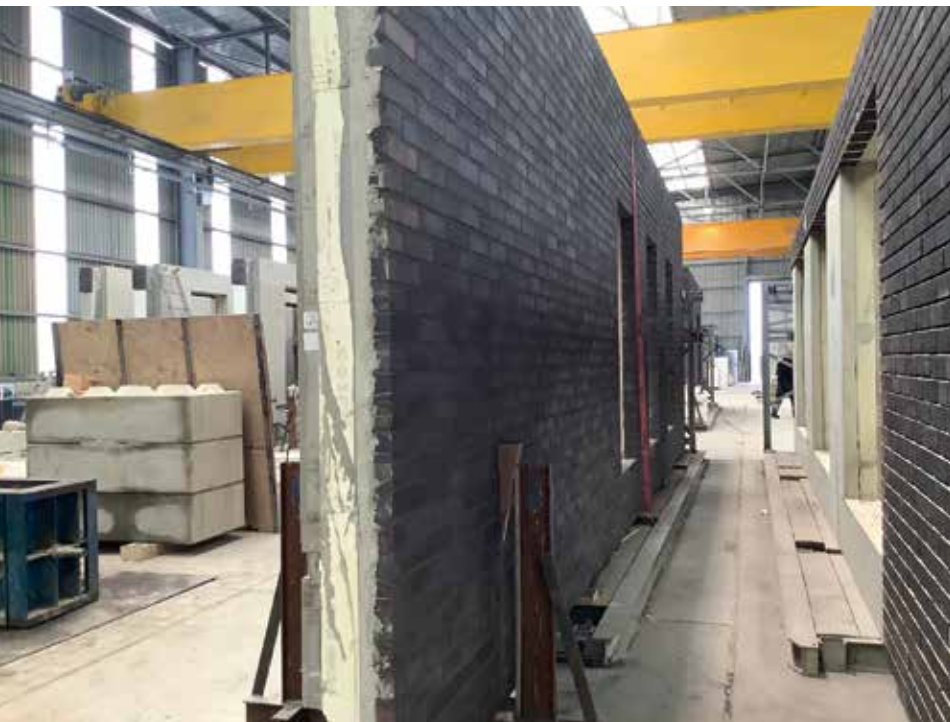
Modulbauwand mit CO2 reduzierten Klinkern
