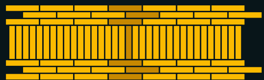
Läuferverband mit Rollschicht
